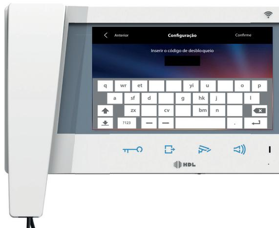
Nota: o acesso à seção “Configuração” é reservado ao técnico instalador; operações incorrectas podem comprometer o bom funcionamento do dispositivo o código padrão é: 12345.
