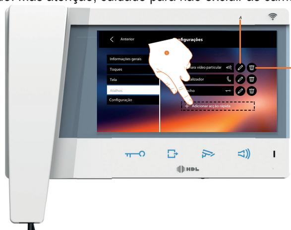
1. Clicar aqui a fim de adicionar uma ação rápida.
