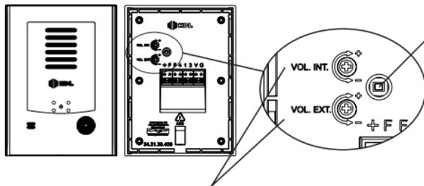
A chave anti-violação dispara o toque de chamada somente se o painel externo for retirado. A função anti-violação não será executada caso a unidade externa seja totalmente retirada. (painel + suporte de fixação).
