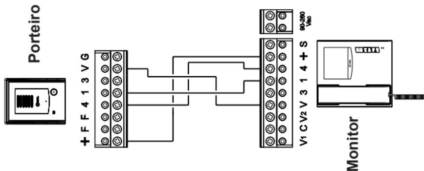
Câmara Auxiliar - Unidade Externa + 1 Unidade Interna + 1 Câmara auxiliar
